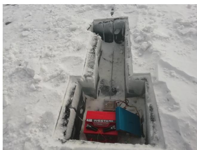
*Рис. 2. Система регистрации и сбора данных деформации и температуры /
